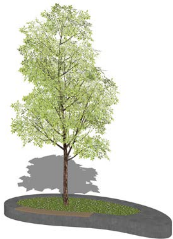
Groenbakken met betonnen (zit)rand in vorm Bisonpoot
